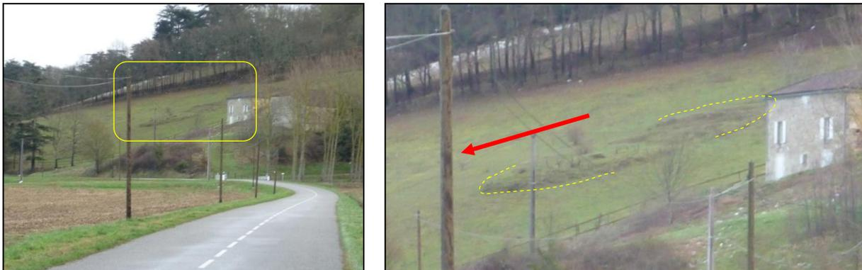
**Figure 22** : Glissement superficiel dans le versant au Nord du Château d'Andas [Source : IMS<sub>RN</sub>]
